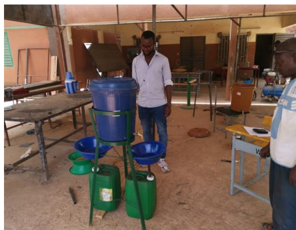
Op de lasopleiding worden de lave-mains gemaakt, de watertonnen om de handen te wassen.
