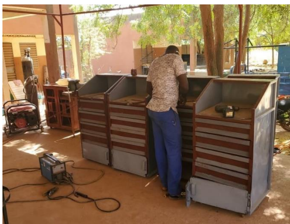
Gereedschapskasten voor de techniekopleidingen worden gemaakt door de lasopleiding.
